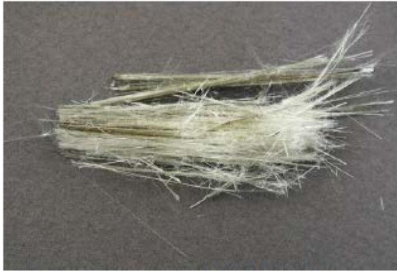
Penge amosite asbestos, 50 mm
