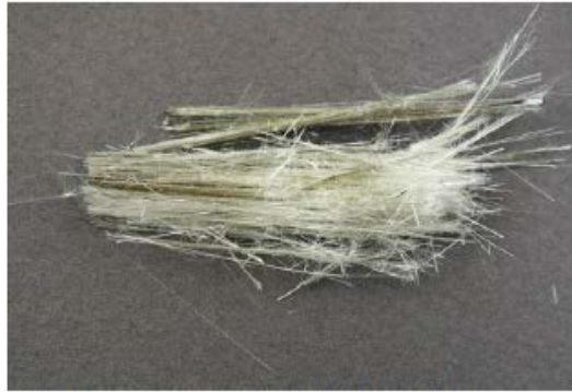
Penge amosite asbestos, 50 mm
